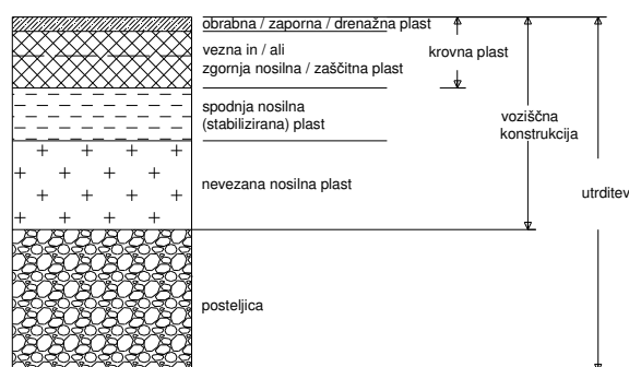
Slika 1.3.1: Značilni prerez voziščne konstrukcije
