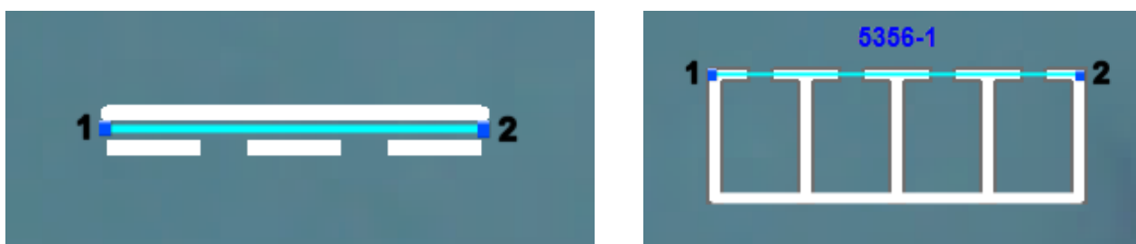
Slika 5: Usmerjenost zajema linije – izris elementov na desni strani nosilne linije
