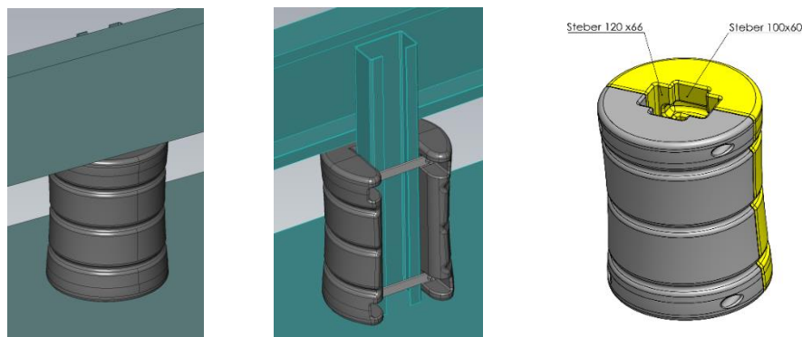
Slika 5, 6 in 7: Zaščita jeklenega stebra varnostne ograje z BTM, enodelni (levo) in dvodelni (desno); [3, 4].
