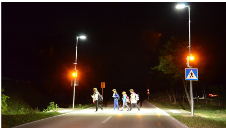
Slika 11. Uporaba dveh svetilk za osvetlitev prehoda za pešce in/ali kolesarje, ki zagotavljata tako primerno horizontalno osvetljenost kot tudi ustrezno vertikalno osvetljenost in s tem dober pozitiven kontrast pešcev na prehodu. Opomba: način uporabe rumene utripajaoče luči, kot je prikazan na sliki, ni več dovoljen – glej Pravilnik o prometni signalizaciji in prometni opreми na cestah (PPSPOC – Uradni list RS, št. 99/15, in 46/17, 59/18 in 63/19)
