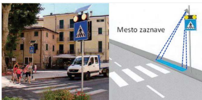
Slika 16. Senzor na prehodu za pešce, ki vključi utripajoče rumene luči, ko se prehodu približajo pešci [6].
