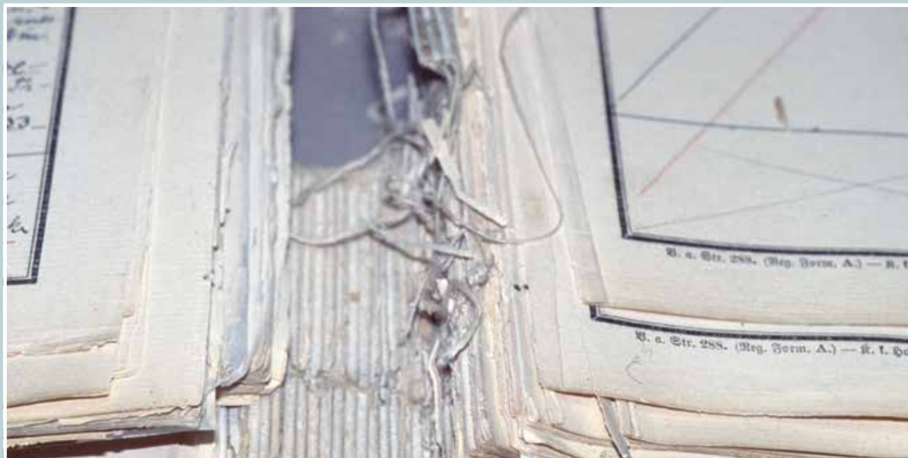
Mehanske poškodbe na hrbtu knjižnega bloka
