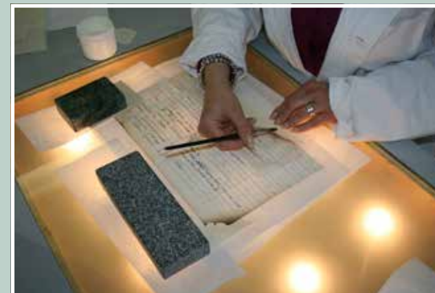
Utrjevanje najbolj poškodovanih delov s tankim japonskim papirjem za povečanje mehanske odpornosti
