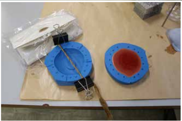
Levo: silikonski kalup z vstavljeno vrvico, s katero je pečat pritrjen na listino. Desno: vosek, vlit v silikonski kalup.
