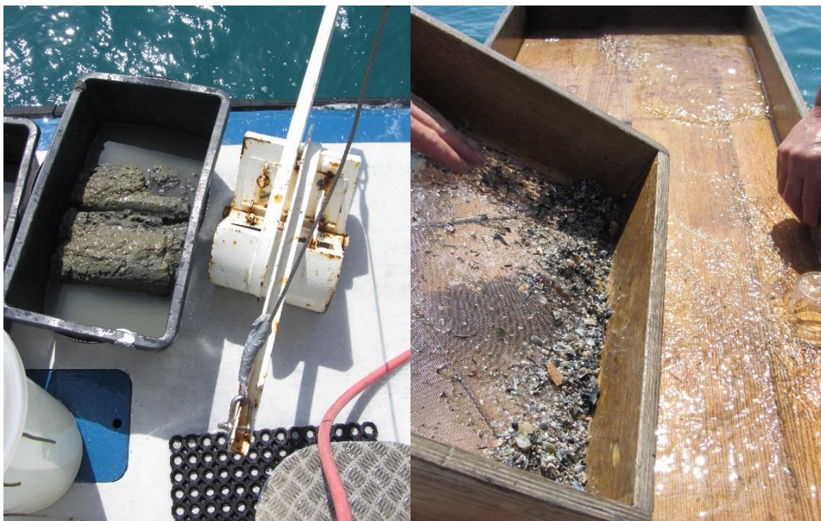
Slika 21. Levo Van Veenovo grabilo za vzorčenje bentoških nevretenčarjev na sedimentnem dnu in podvzorec bentoških nevretenčarjev, desno izpiranje podvzorca bentoških nevretenčarjev, foto: arhiv ARSO
