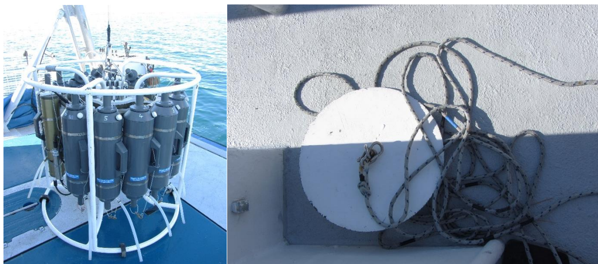
Slika 20. Levo Niskinov vzorčevalnik za vzorčenje vode na različnih globinah, desno Secchijeva plošča za ugotavljanje prosojnosti vode, foto: arhiv ARSO
