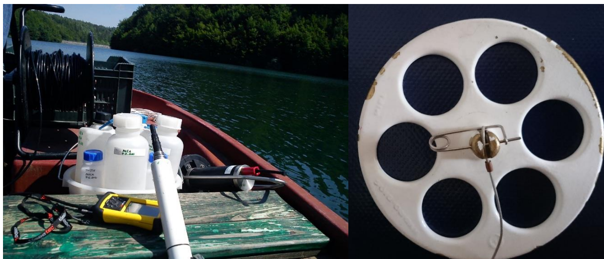
Slika 6. Levo oprema za vzorčenje fizikalno-kemijskih parametrov na čolnu, desno Secchijeva plošča za merjenje prosojnosti vode v jezerih in zadrževalnikih, foto: arhiv ARSO
