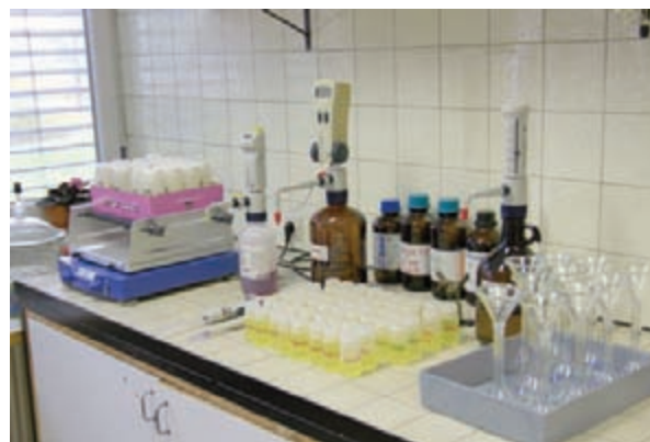
Slika 31: Analitski postopki za določanje kemijskih lastnosti tal vključujejo fazo ekstrakcije talnega vzorca z ekstrakcijskimi raztopinami.
