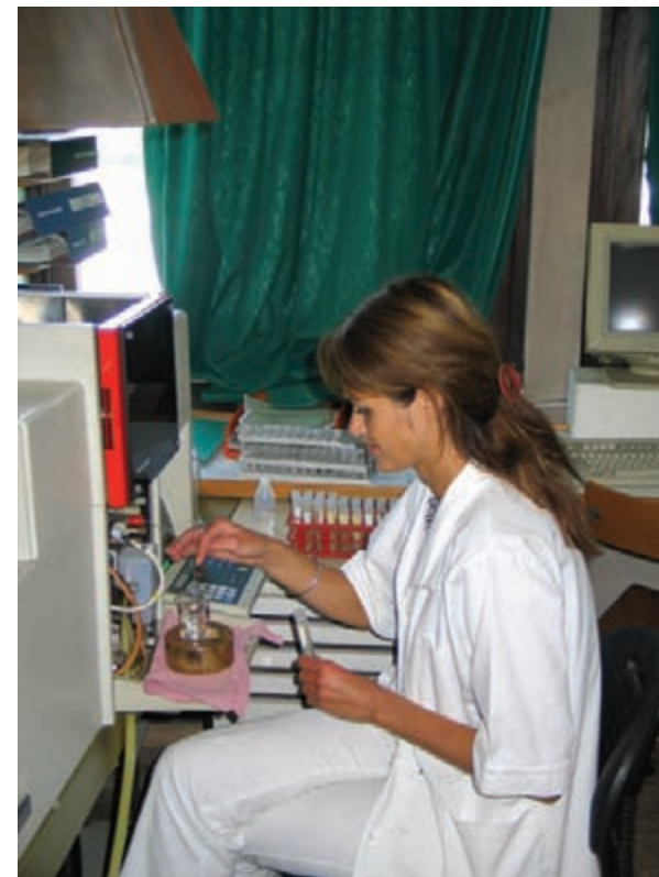
Slika 38: Koncentracijo elementov v talnih vzorcih merimo z atomskim absorpcijskim spektrofotometrom.
