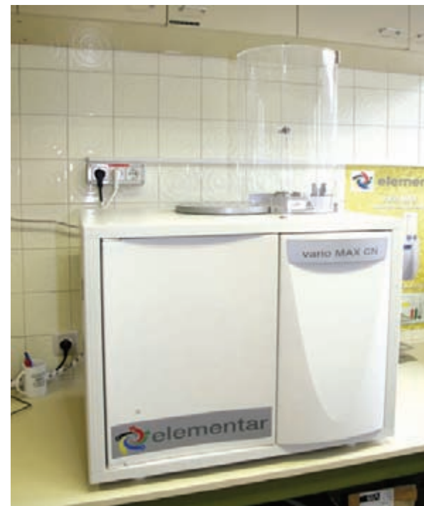
Slika 37: CN analizator za določanje organskega ogljika in skupnega dušika v tleh.
