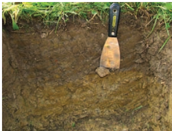
Slika 19: Na odvzemnem mestu izkopljemo talni profil do globine 30 cm in po slojih povzorčimo tla.
