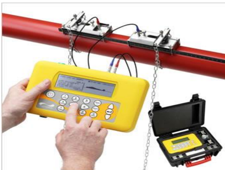
Slika 7: Prenosni merilnik pretoka za zunanjo neinvazivno vgradnjo
