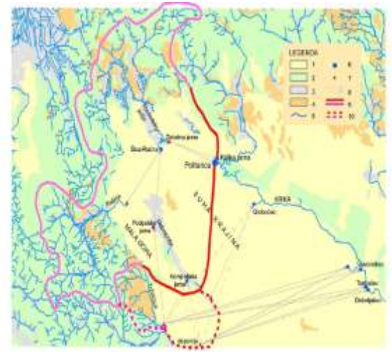
Slika 3: Hidrogeološka karta zaledju izvira (Legenda: 1. kraški vodonosnik, 2. razpokinski vodonosnik, 3. medzavski vodonosnik, 4. zelo slabo prepustne kamnine, 5. površinski tok, 6. izvir, 7. točke injiciranja pri sledilnem poskusu, 8. s sledenjem dokazane glavnine in stranskega podzemne vodne zveze, 9. kraljica in nekraljica razvodnica, 10. kraljica in nekraljica meja dela zaledju izvira Karke, ki pa se pretično doteka proti drugim izvirov). (Geološka osnova: Digitalne litološke karte, ki so jih v raziskovalne namene dobavili na Geološkem zavodu Slovenije).
