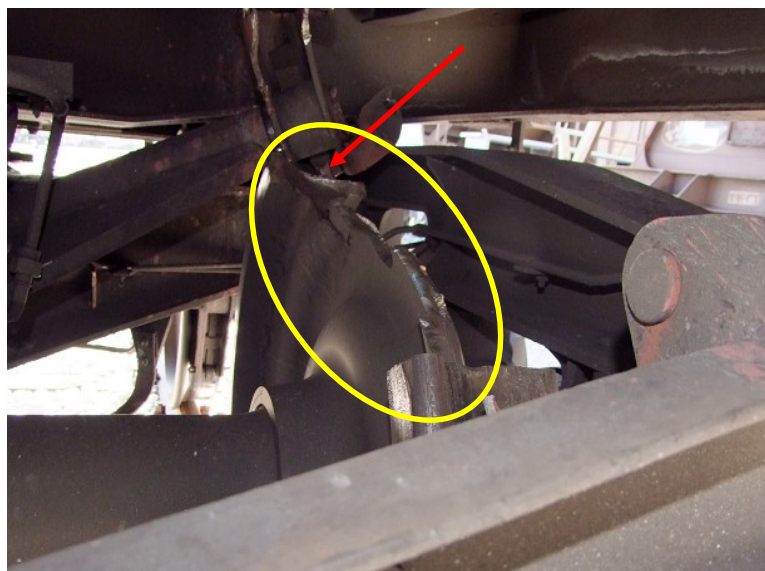
Slika št. 3: Rdeča puščica prikazuje točko zagozdenja zavornega čevlja v rob odlomljenega kolesa, rumeni romb pa področje zloma kolesa.
