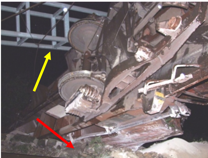
Slika št. 1: Prikazuje uničen vagon Tadds-z, ki se je zagozdil ob zrušen portal vozne mreže označen z rumeno puščico in oporni zid brežine tira št. 4 označen z rdečo puščico
