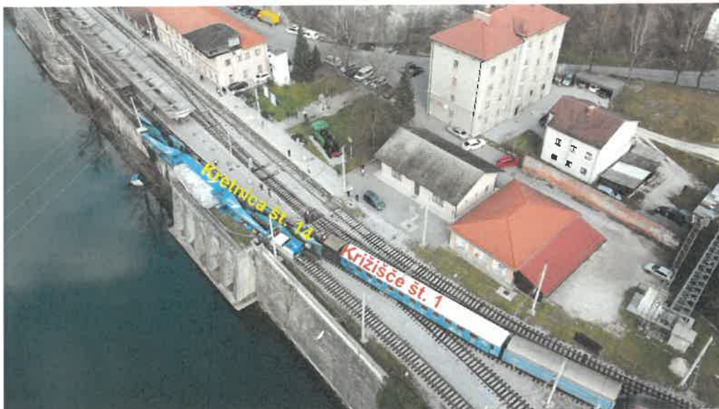
Slika št. 5: Prikazuje oviro v vlakovnem prometu zaradi vlaka, ki je prevažal izredno pošiljko, ki je s kljunasto nosilno konstrukcijo in premostitvenimi elementi zdrsnila iz vagona Uaai. Promet je bil onemogočen po kretnici št. 14 ter po križišču št. 1.
