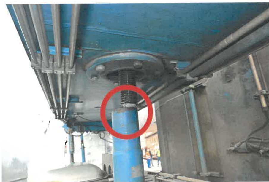
Slika št. 14: Rdeči krog označuje zlomljeno navojno os na A-1 strani vagona
