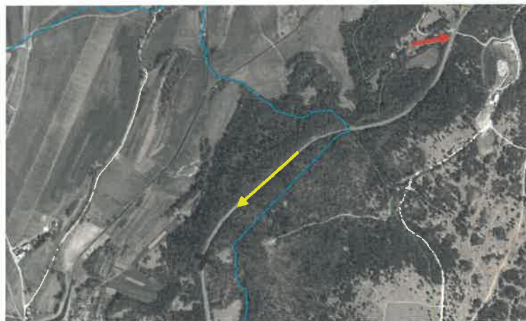
Slika št. 11: Prikaz konfiguracije terena po katerem poteka proga, rdeča puščica označuje mesto postavitve signalnih oznak 207: »Mesto dela na progi«, črn križ označuje lokacijo nesreče z rumeno puščico pa je označena smer vožnje vlaka št. 2674.
