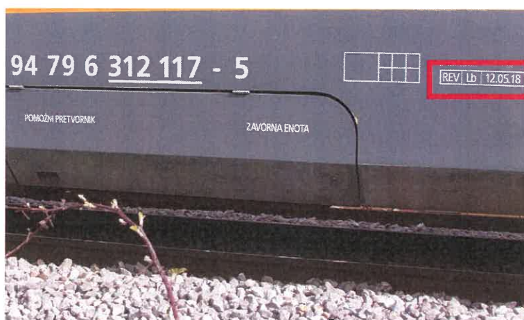
Slika št. 14: Z rdečim pravokotnikom je označen revizijski pregled EMG 312-117/118 317-109.
