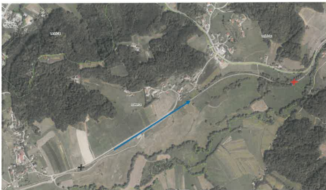
Slika št. 9: Črni križ prikazuje točko prvih sledi iztirjenja na pritrdilnih vijakih tirnice rdeč križ mesto ustavitve lokalnega potniškega vlaka št. 3701 po iztirjenju, modra puščica pa smer vožnje vlaka.
