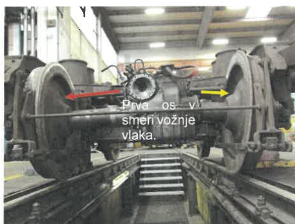
Slika št. 6: Rdeča puščica prikazuje kolo, ki je iztirilo bilo pa je nameščeno na daljšem delu osi od zobnika, rumena puščica pa prikazuje levo kolo, ki je bilo nameščeno na krajšem delu osi, ki se je prelomila pri zobniku.
