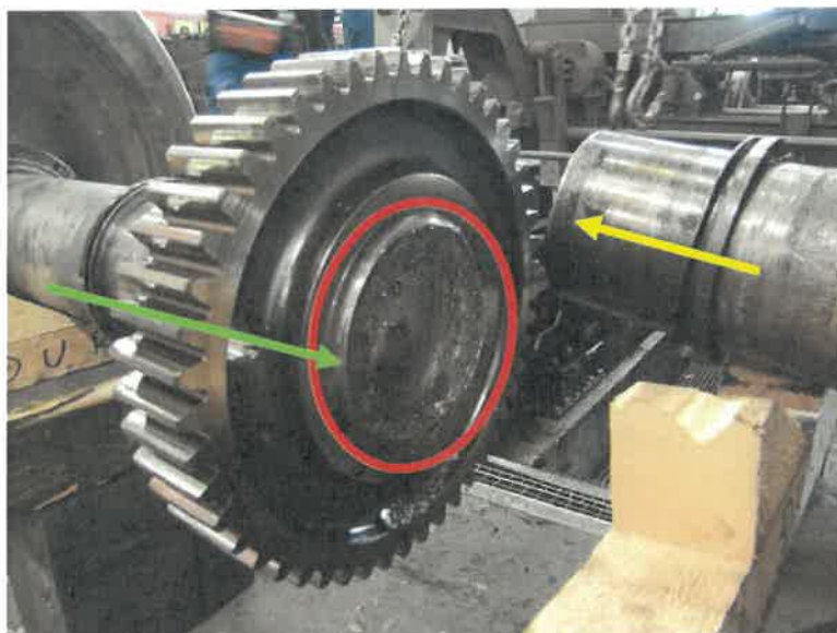
Slika št. 1: Rdeč romb označuje mesto zloma osi neposredno ob pogonskem zobniku na katerega se vpne pogonski prenos - kardan, rumena puščica ponazarja desno in stran osi v smeri vožnje vlaka, zelena pa levo.
