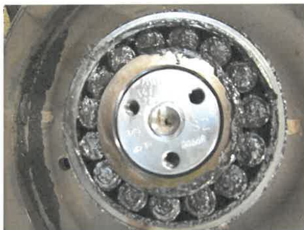
Slika št. 7: Ponazarja stanje ležajev na čepih osi. Vgrajeni valjčni ležaji so bili podmazani in brez napak.
