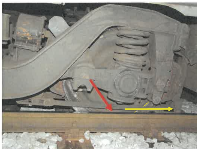
Slika št. 5: Rdeča puščica prikazujeta položaj iztirjenega desnega kolesa druge osi drugega podstavnega vozička DMG 813-130, rumena pa smer vožnje vlaka.
