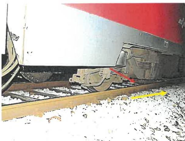
Slika št. 2: Rumena puščica na fotografiji prikazuje smer vožnje vlaka na desni strani podstavnega vozička rdeča pa iztirjeno desno kolo zlomljene prve osi drugega podstavnem vozičku DMG 813-130.
