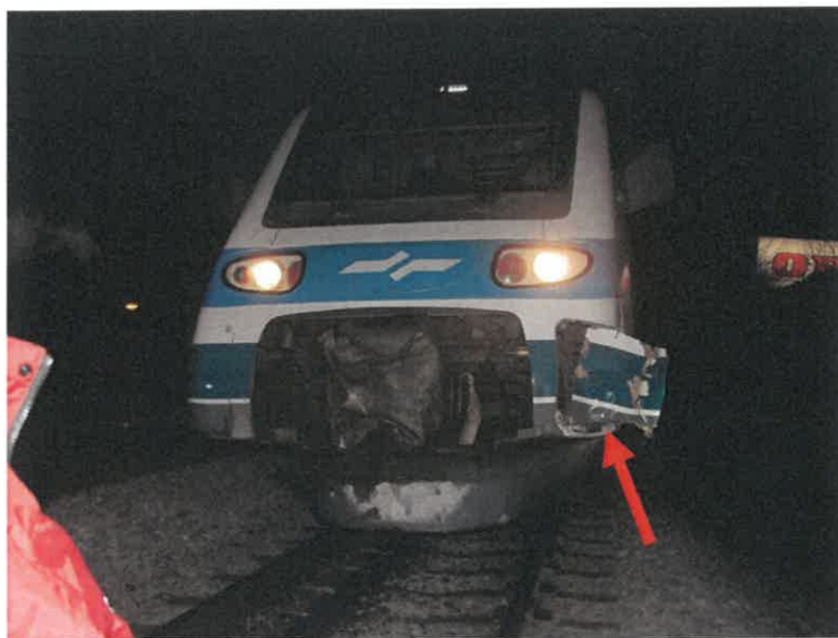
Slika št. 2: Fotografija poškodb čela EMG 310-003, ki so nastale ob trčenju vlaka št. 518 v mladoletno dekle.
