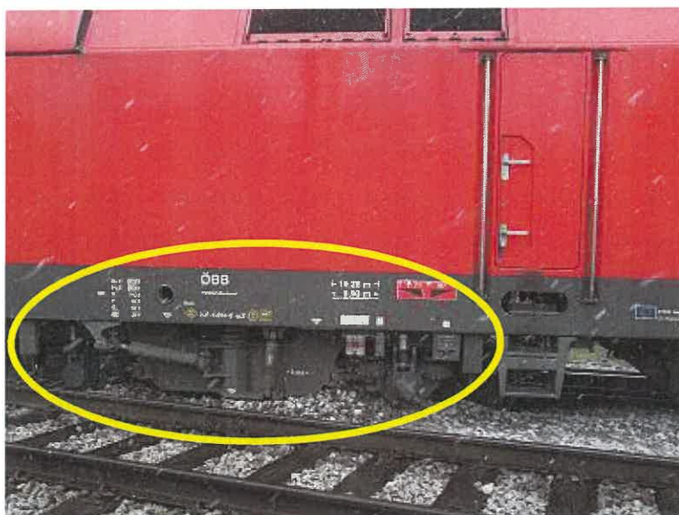
Slika št. 3: Z rumeno elipso so označene posledice iztirjenja drugega podstavnega vozička lokomotive št. 1116-025, ki je bilo povod za vpeljavo preiskovalnega postopka.
