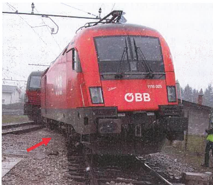
Slika št. 2: Fotografija iztirjenja lokomotive 1116-025 s prvim podstavnim vozičkom na zveznem tiru kretnic št. 60 in 49, z drugim podstavnim vozičkom pa v medtirju zveznega tira kretnic št. 60 in 49 ter zveznega tira kretnic št. 55 in 60.
