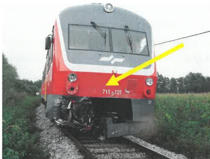
Slika št. 12: Rumena puščica prikazuje poškodbe čelne strani krmilne enote DMG 715-125, vlaka št. 3375.
