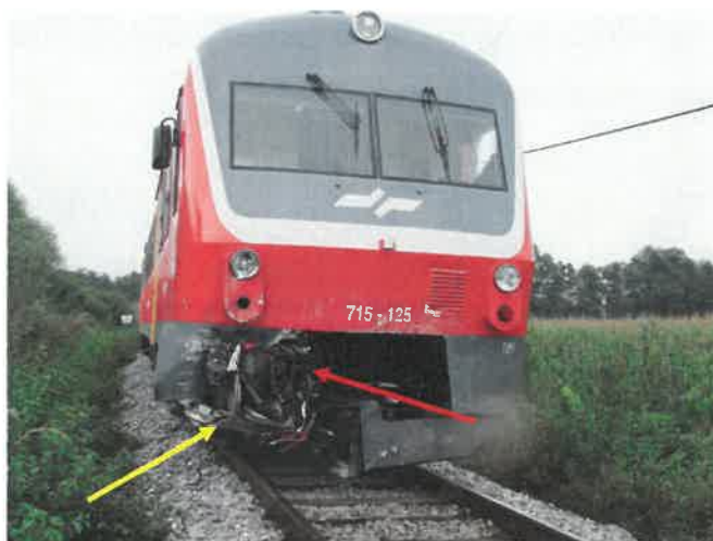
Slika št. 3: Rdeča puščica prikazuje uničeno avtomatsko spenjačo vlaka št. 3375, rumena pa desno stran čela krmilne enote DMG 715-125
