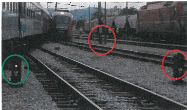
Slika št. 7: Zeleni krog označuje premikalni signal 108D, ki kaže signalni znak št. 28: »Premik dovoljen« rdeča pa označujeta premikalna signala 108L in 105L, ki kažeta signalna znaka št. 28: »Premik prepovedan«.
