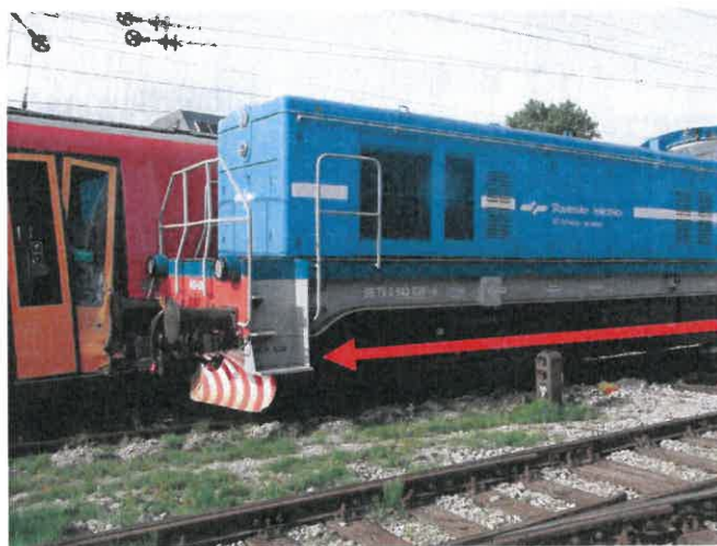
Slika št. 2: Fotografija trčenja D-lok 643-038 z desnim vogalom čela v bok EMG 312-121/122, na kretnici št. 105, rdeča puščica prikazuje smer vožnje obeh premikalnih sestavov.
