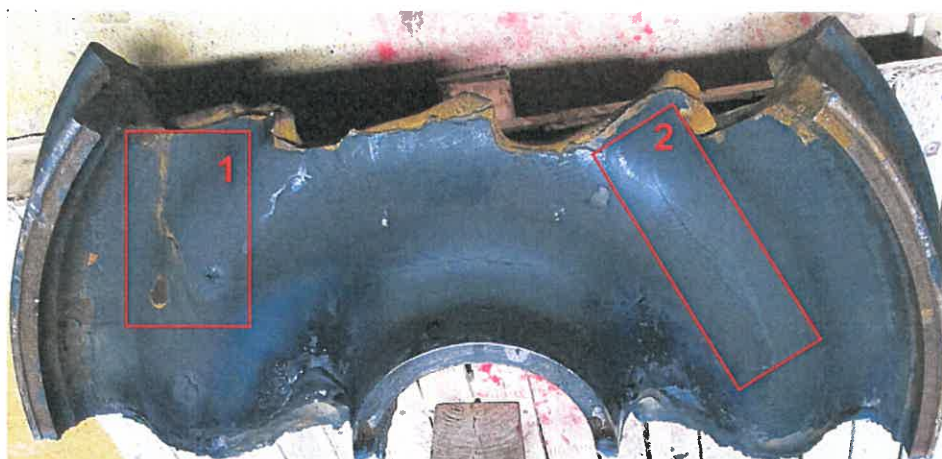
Slika 17: Prikaz namestitve RTG filmov in njihovi označbi.
