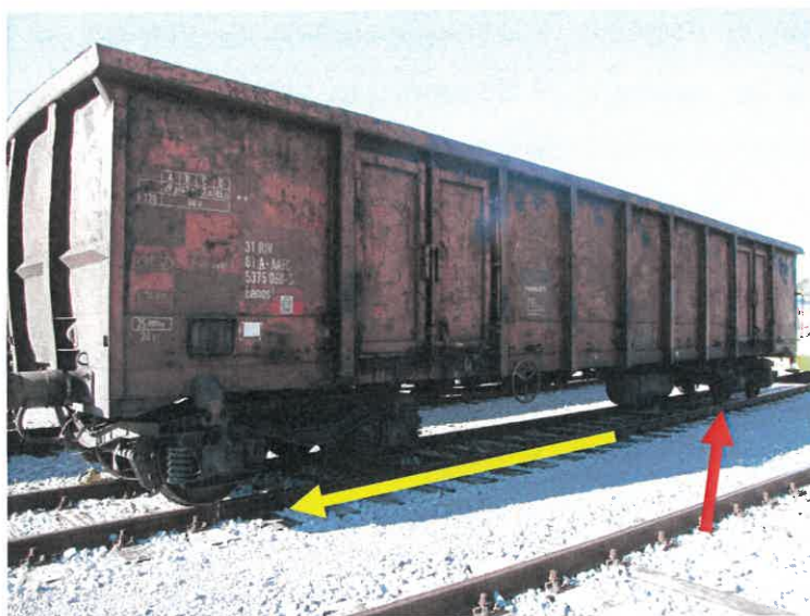
Slika št. 12: Rdeča puščica prikazuje zlomljeno kolo na vagonu, rumena pa smer vožnje v vlaku.
