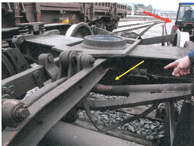
Slika št. 6: Rdeča puščica prikazuje manjši kmetijski traktor, ki je prirejen za industrijske namene in s katerim je bila opravljena odstavitev poškodovanega vagona od vlaka št. 53202, rumena pa mest skrivljenega zavornega trikota.
