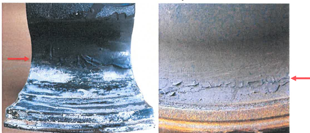
Slika 20: Izgled premaza na preizkušancu št. 224.4 po ohladitvi (levo) ter kolesu po lomu (desno, vir fotografije: naročnik)
