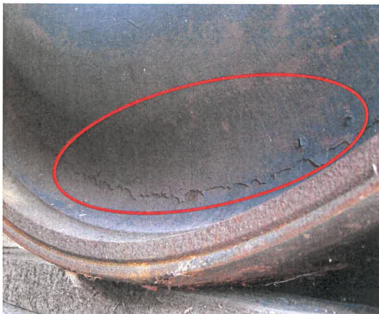
Slika št. 21: Rdeč romb prikazuje rob barve na zunanji strani monobloka zlomljenega kolesa ki je izgorela zaradi termične preobremenitve.
