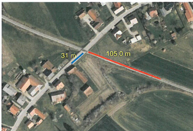
Slika št. 6: Modra premica označuje razdaljo proge od nivojskega prehoda, v smeri Ljutomera, na kateri je zagotovljena preglednost iz ceste, rdeča premica pa razdaljo na progi v kateri je neovirana preglednost iz ceste v smeri postaje Ljutomer.
