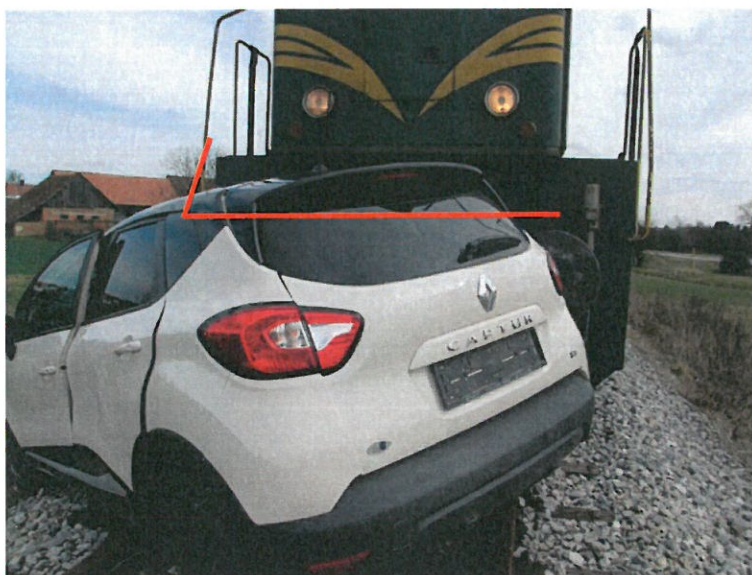
Slika št. 8: Pravi kot rdeče barve označuje kot trčenja vlaka v cestno vozilo, motorno vozilo je zaradi težišča vozila, med potiskanjem z vlakom po progi vse do zaustavitve, rinilo v desno.
