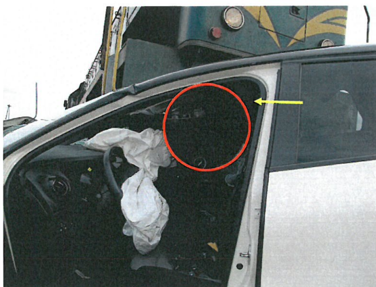
Slika št. 4: Rdeči krog označuje desni odbojnik lokomotive 664-116, ki je med trčenjem prebil steklo desnih sprednjih vrat cestnega vozila, rumena puščica pa vzglavnik vozniskega sedeža v cestnem vozilu.
