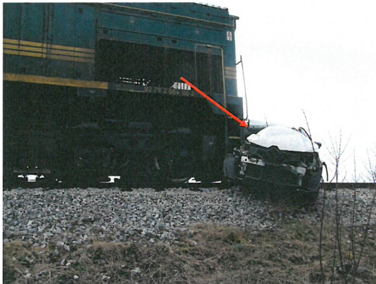
Slika št. 7: Rdeče puščice označujejo desni odbojnik lokomotive 664-116, na katerega se je zataknilo cestno vozilo, ki ga je vlak potiskal pred sabo do zaustavitve.
