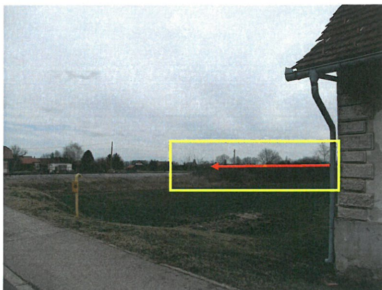
Slika št. 16: Rdeča puščica prikazuje smer vožnje vlaka, rumeni romb pa vegetacijo (drevesa, visoko grmovje), ki zastira preglednost na nivojski prehod iz smeri proge od postaje Ljutomer v smeri nezasedenega nakladališča Gornja Radgona.
