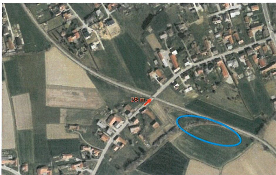
Slika št. 3: Rdeča puščica označuje razdaljo od stavbe Boreci 24 do nivojskega prehoda, moder romb pa vegetacijo, ki zastira preglednost na progo proti postaji Ljutomer.
