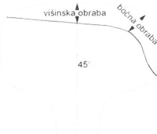
Slika št. 33: Prikaz načina meritve višinske in bočne obrabe tirnice skladno s pravilnikom.
