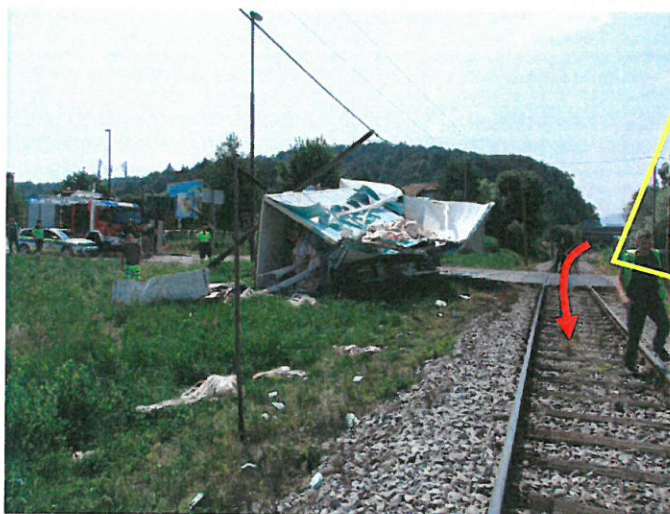
Slika št. 16: Rdeča puščica prikazuje smer vožnje vlaka rumeni trikotnik pa vegetacijo - visoko rastje, ki zastira preglednost na nivojski prehod iz ljubljanske smeri proge.
