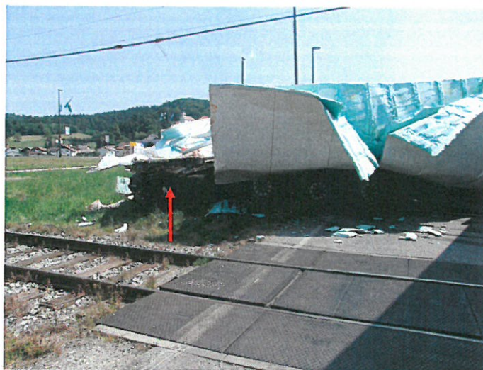
Slika št. 11: Rdeča puščica prikazuje točko trčenja lokalnega potniškega vlaka št. 3220 v polpriklopnik cestnega tovornega motornega vozila na NPr 146.5 med postajama Ljubljana Rakovnik in Škofljica, ki ga je vlak odrinil iz svetlega profila proge.
