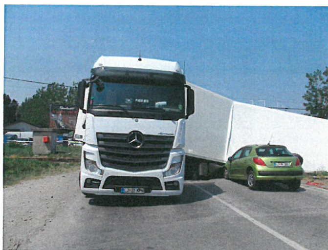
Slika št. 8: Prikaz posledic trčenja, odrinjen polpriklopnik, ki ga je vlak št. 3220, po trčenju odrinil iz desnega na levi smerni pas cestišča, kjer je nasedel na pokrovu motorja cestnega osebnega motornega vozila.
