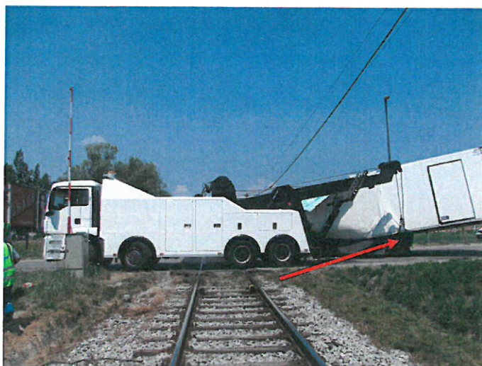
Slika št. 7: Rdeča puščica prikazuje vpetje interventnega vozila na polpriklopnik med dvigom iz sedla vlečnega vozila.
