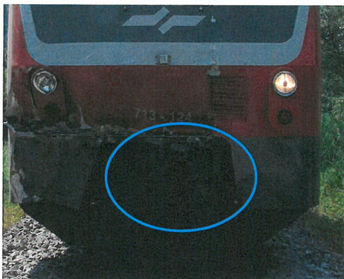
Slika št. 9: Moder romb označuje, poškodovano avtomatsko spenjalno napravo DMG 713-124.
