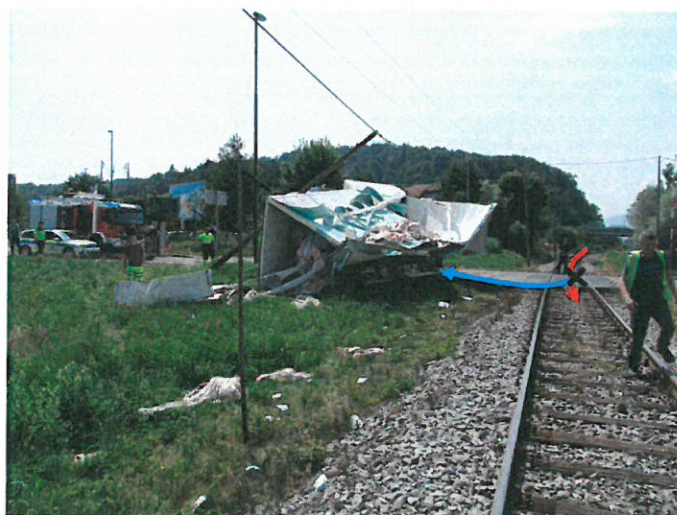
Slika št. 4: Z rdečo puščico je označena smer vožnje lokalnega potniškega vlaka št. 3220, s črnim križem točko nahajanja zadnjega dela polpriklopnika v profilu železniške proge, z modro puščico pa je označena smer odtravanja polpriklopnika cestnega tovornega motornega vozila po trčenju.
