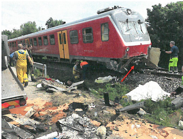
Slika št. 6: Rdeča puščica označuje poškodbo avtomatske spenjače na čelu krmilne enote DMG 715-105.
