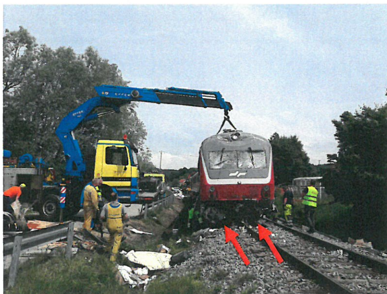
Slika št. 9: Rdeči puščici prikazujeta iztirjeni kolesi prve osi prvega osnovnega vozička krmilne enote DMG 715-105.
