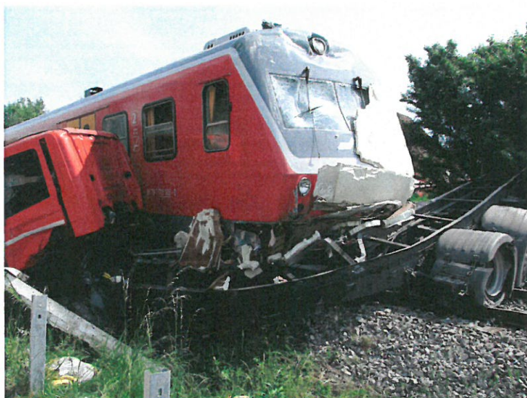
Slika št. 10: Prikaz posledic trčenja lokalnega potniškega vlaka št. 3281 v cestno tovorno motorno vozilo na NPr 146.5 med postajama Ljubljana Rakovnik in Škofljica.
