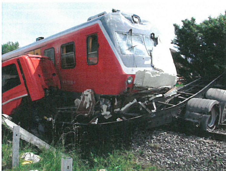
Slika št. 3: Posledice trčenja dizel motorne garniture s čelom krmilne enote DMG 715-105, v desni bok cestnega tovornega motornega vozila.
