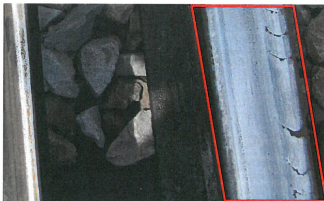
Slika št. 23: Rdeči romb prikazuje deformacijo glave desne osnovne tirnice kretnice št. 1, ki se je bila nasproti točke naplezanja sledilnih vencev levih koles prvega osnovnega vozička vlakovne lokomotive 363-013, vlaka št. 41914.
