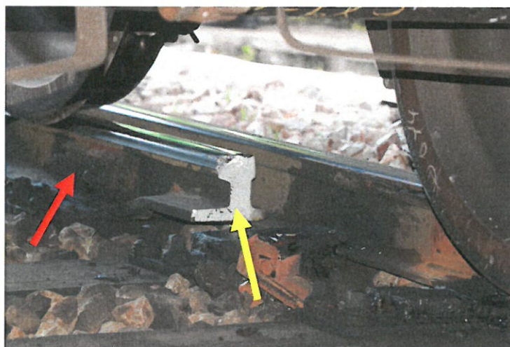
Slika št. 20: Rdeča puščica prikazuje točko v kateri je ostrica privarjena ob tirnico rumena puščica pa točko zloma za prehodom iz normalnega profila tirnice v zmanjšano dimenzijo ostrice
