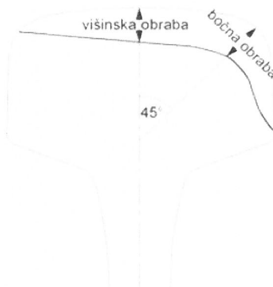
Slika št. 33: Prikaz načina meritve višinske in bočne obrabe tirnice skladno s pravilnikom.
