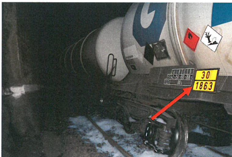
Slika št. 16: Rdeča puščica prikazuje tablo za nevarno snov v vagonu
