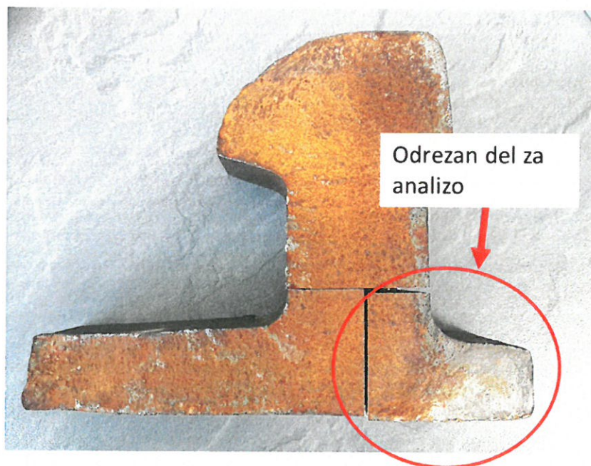
Slika št. 39: Prikazan način razreza in mesto odvzema vzorca za nadaljnjo analizo.
