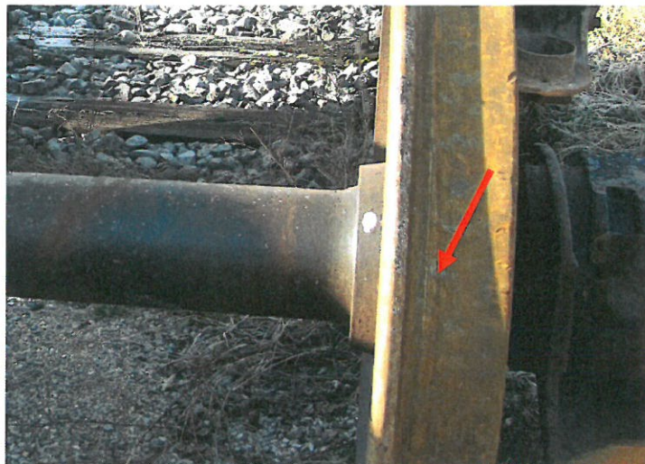
Slika št. 8: Rdeča puščica prikazuje brazdo na tekalni površini desnega kolesa prve osi iztirnjenega podstavnega vozička v smeri vožnje vlaka
