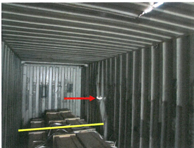
Slika št. 19: rdeča puščica označuje poškodbo desne stene kontejnerja rumena črta pa višino do katere so bili naloženi zaboji v kontejnerju
