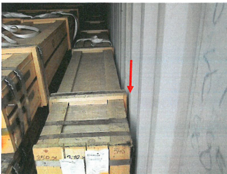
Slika št. 21: Rdeča puščica prikazuje položaj zabojev ob desni steni drugega zabojnika na iztirjenem vagonu gledano v smeri vožnje vlaka
