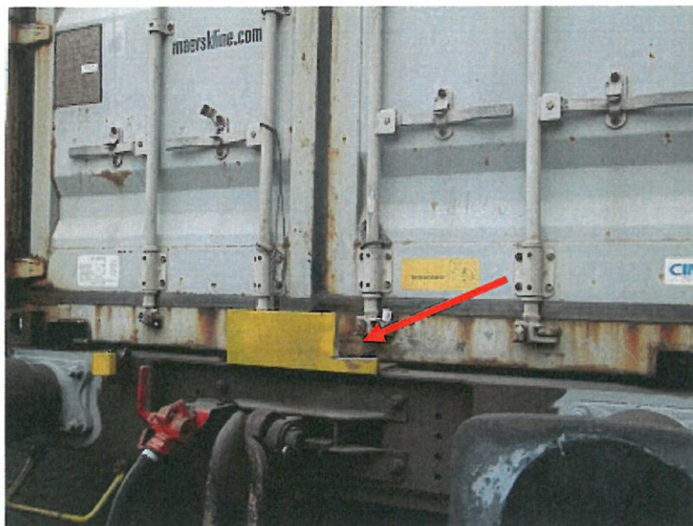
Slika št. 5: Rdeča puščica prikazuje odrezan del kovinske zaščite privarjene na konstrukcijo poda vagona, ki onemogoča odprtje vrat kontejnerja, ko je naložen na vagon
