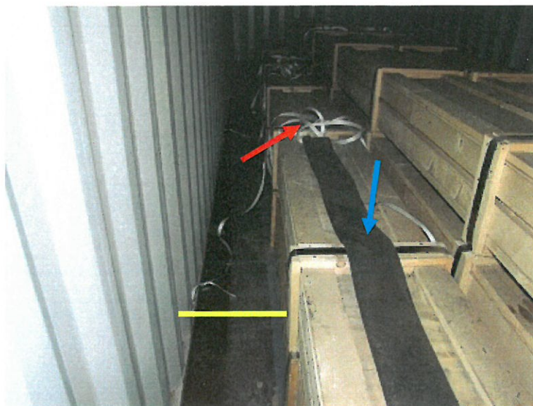
Slika št. 20: Rdeča puščica prikazuje potrgane privezne trakove, modra gumi trak, ki je bil položen na PVC folijo pod naležne deščice zabojev, rumena črta pa odmik zabojev od leve stene drugega zabojnika na iztirjenem vagonu gledano v smeri vožnje vlaka
