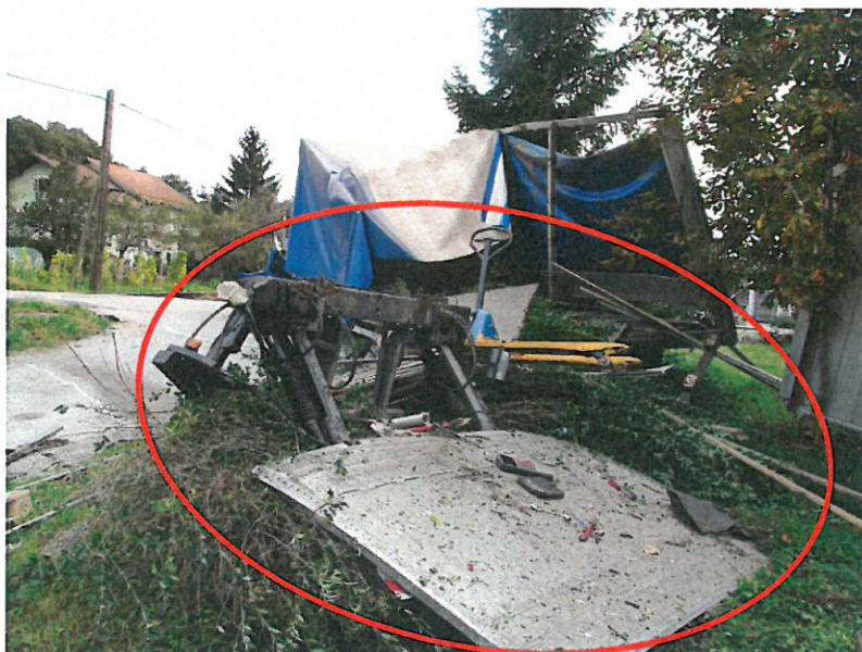
Slika št. 8: Rdeči romb prikazuje odtrgano nakladalno klančino iz zadnje strani nakladalnega dela cestnega tovornega motornega vozila, ki je po trčenju deformirana obležala ob vozilu.
