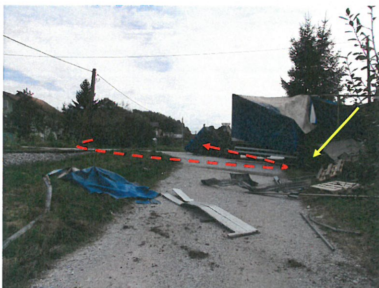
Slika št. 4: Rdeča prekinjena puščica ponazarja pot cestnega tovornega motornega vozila po trčenju vlaka, rumena pa točko trčenja dizel motorne garniture s čelom krmilne enote DMG 715-122, v zadnje kolo levega boka cestnega tovornega motornega vozila.
