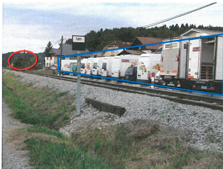
Slika št. 5: Pogled na progo iz nivojskega prehoda zastirajo drevesa ob stanovanjski hiši Dolenjska cesta št. 432, ki so označena z rdečim romбом in vozila, ki so parkirana pri pekarni Pečjak, Dolenjska ceste 442, označena z modrim trapezom.
