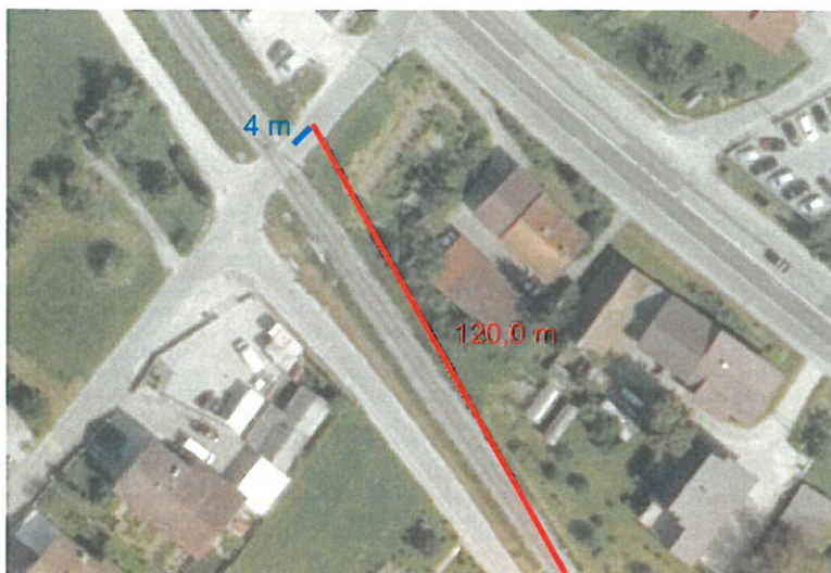
Slika št. 6: Modra premica označuje pot tovornega motornega vozila, ki jo je moral z vozilom opraviti voznik preden je zapeljal v nevarno območje proge, v trenutku, ko se je vlak nahajal vsaj 120,0 m pred nivojskim prehodom kar označuje rdeča premica.
