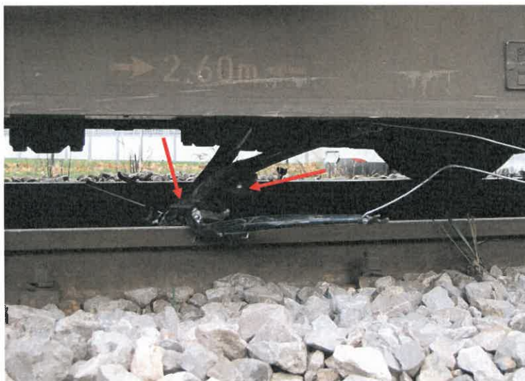
Slika št. 4: Rdeča puščica prikazuje zavorne gumice kolesa na sprednjem kolesu.
