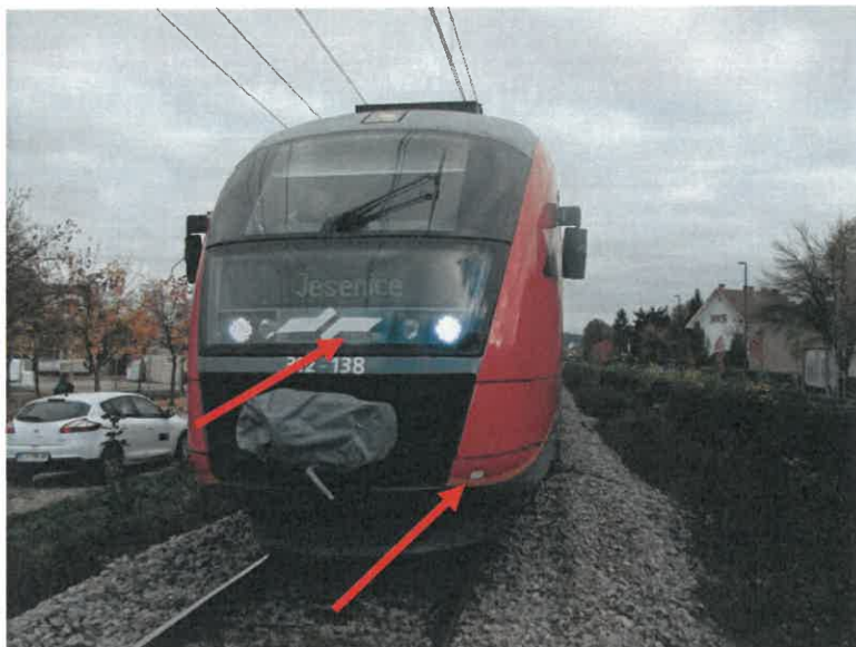
Slika št. 9: Z rdečo puščico so označen poškodbe na EMG 312-138 v nesreči udeleženega vlaka št. 2408.
