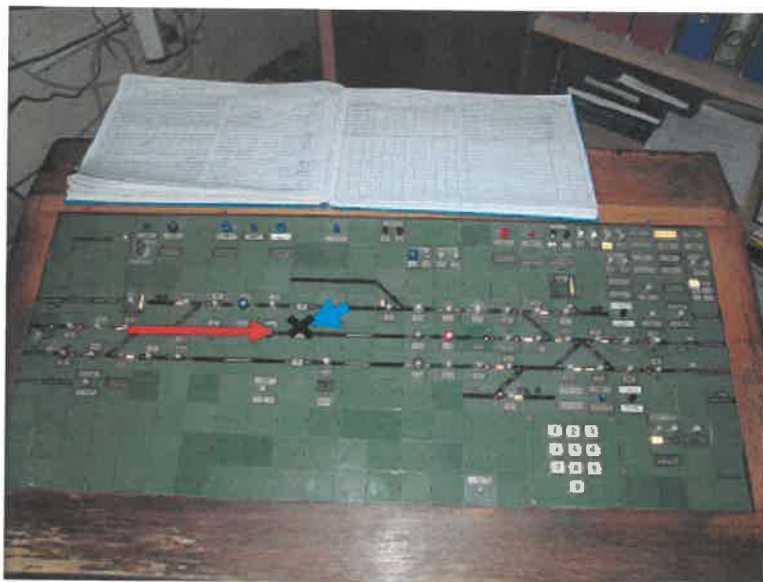
Slika št. 1: Na postavljalni mizi ERSV naprave postaje Kresnice rdeča puščica označuje vozno pot ICS potniškega vlaka št. 20, modra puščica gibanje delavca proti svetlemu profilu tira št. 2, črn križ pa točko trčenja vlaka v delavca.
