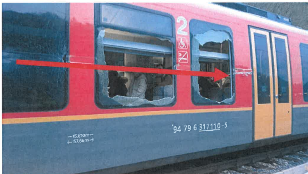
Slika št. 7: Rdeča puščica prikazuje smer drsanja vlečnega elementa TMD 436-001 po DMG 312-119/120 in 317-110 vlaka št. 18
