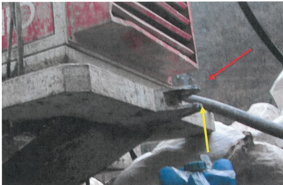
Slika št. 5: Rdeča puščica prikazuje povečavo vlečnega elementa samohodnega vrtnega stroja na gosenicah, rumena pa točko po kateri je podrsal vlak št. 18
