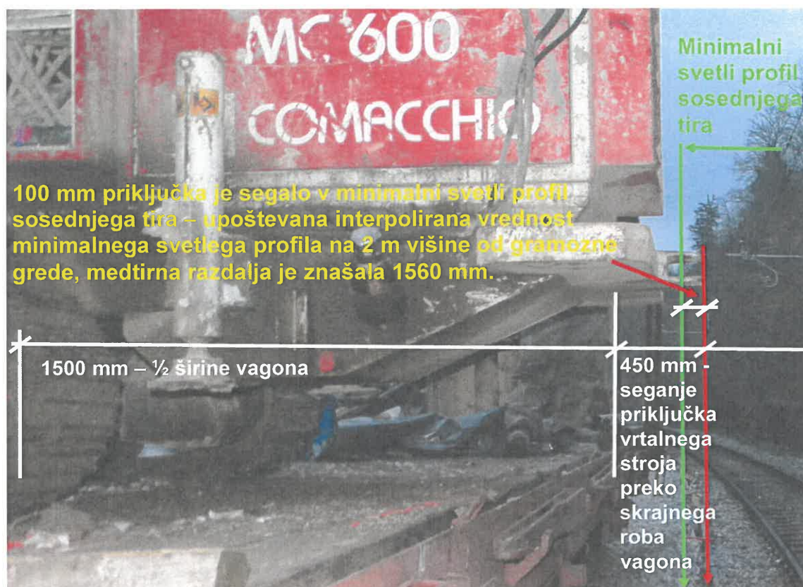
Slika št. 2: Izmere minimalnega svetlega profila proge med levim in desnim tirom na kraju oplaznja vlaka št. 18 z vlečnim elementom delovnega vrtnega stroja
