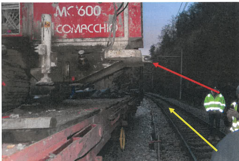
Slika št. 4: Rdeča puščica prikazuje vlečni element samohodnega vrtalnega stroja na gosenicah, ki ga je med srečevanjem oplazil vlak št. 18, ki je vozil po sosednjem desnem tiru v smeri rumene puščice
