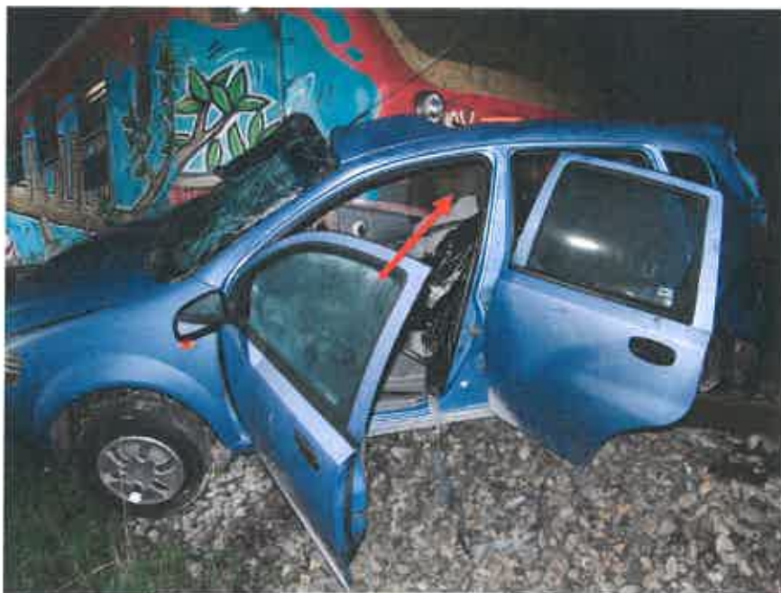
Slika št. 2: Rdeča puščica prikazuje odbojno napravo DMG, ki je ob trčenju poškodovala sopotnico
