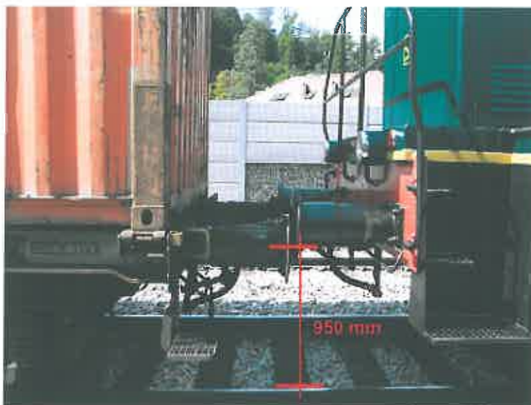
Slika št. 6: Višina sredine odbojnika od gornjega roba tirnice
