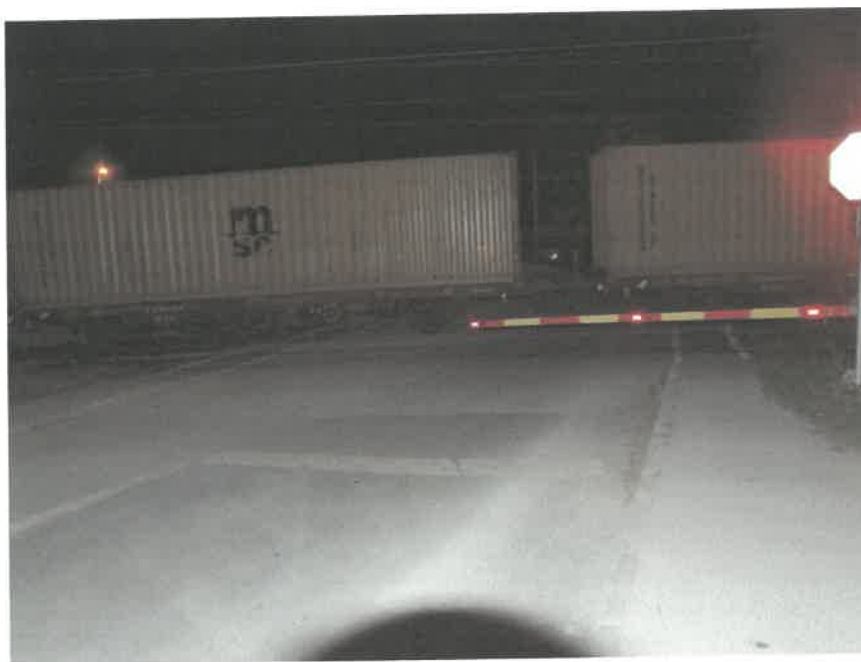
Slika št. 2: Prikazuje delovanja naprave za zavarovanje nivojskega prehoda, neposredno po nesreči, v času, ko je na nivojskem prehodu zaradi odpravljanj posledic še vedno stal v nesreči udeležen vlak
