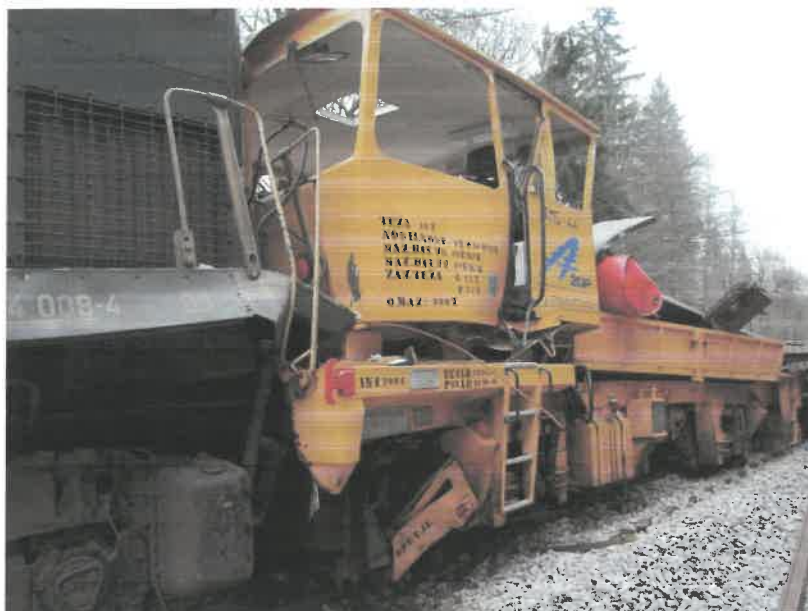
Slika št. 3: Posledice trčenja delovnega vlaka št. 90433 s progovnim vozilom TMD-44
