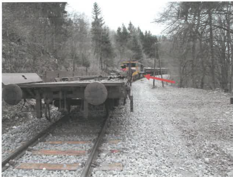
Slika št. 2: Prikaz mesta trčenja delovnega vlaka in progovnega vozila označuje rdeča puščica
