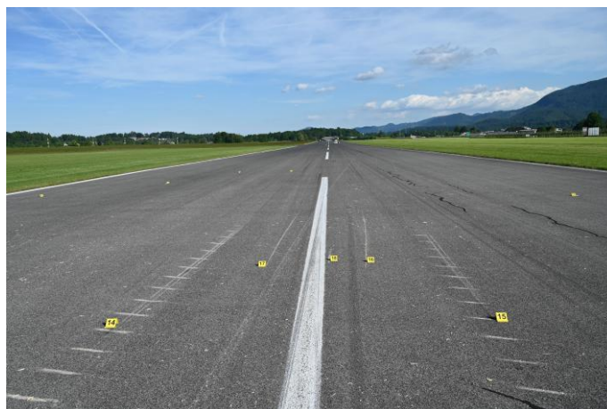
Slika 3: OE-FPV trki s propelerji ob VPS v fazi vzleta
