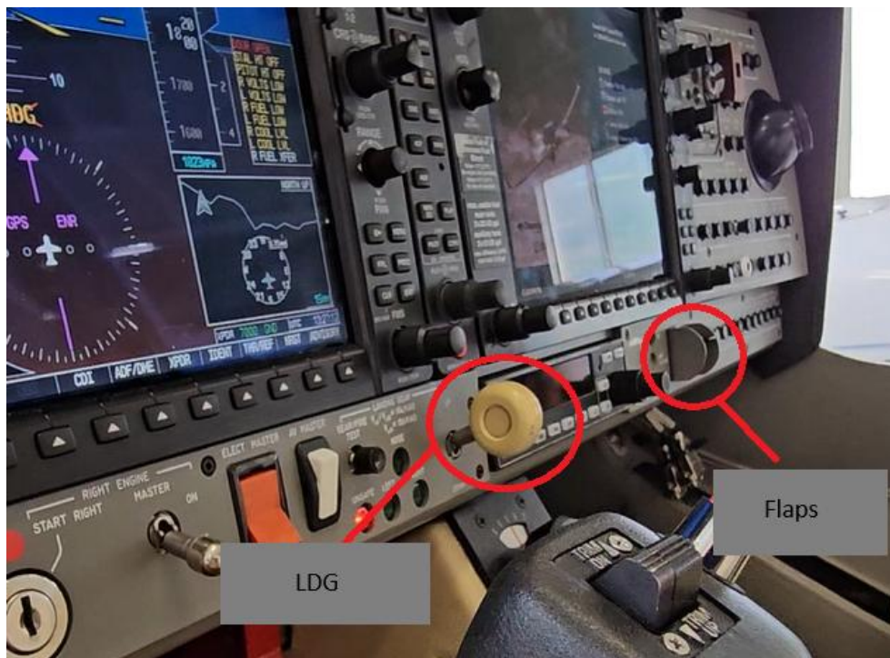
Slika 4: OE-FPV pozicija komand za konfiguracijo - levo LDG desno flaps
