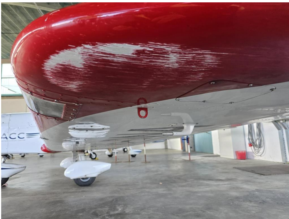
Slika 5: Poškodbe letala - krilo
