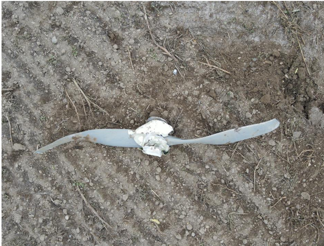
Slika 2: Kraki zlomljenega propelerja na mestu dogodka
