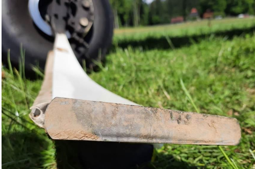
Slika 8: Del vzmetne noge, ki je obležal v travi
