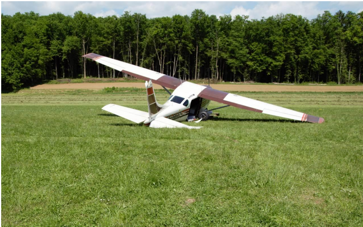
Slika 1: Položaj letala po zlomu desne vzmetne noge podvozja
