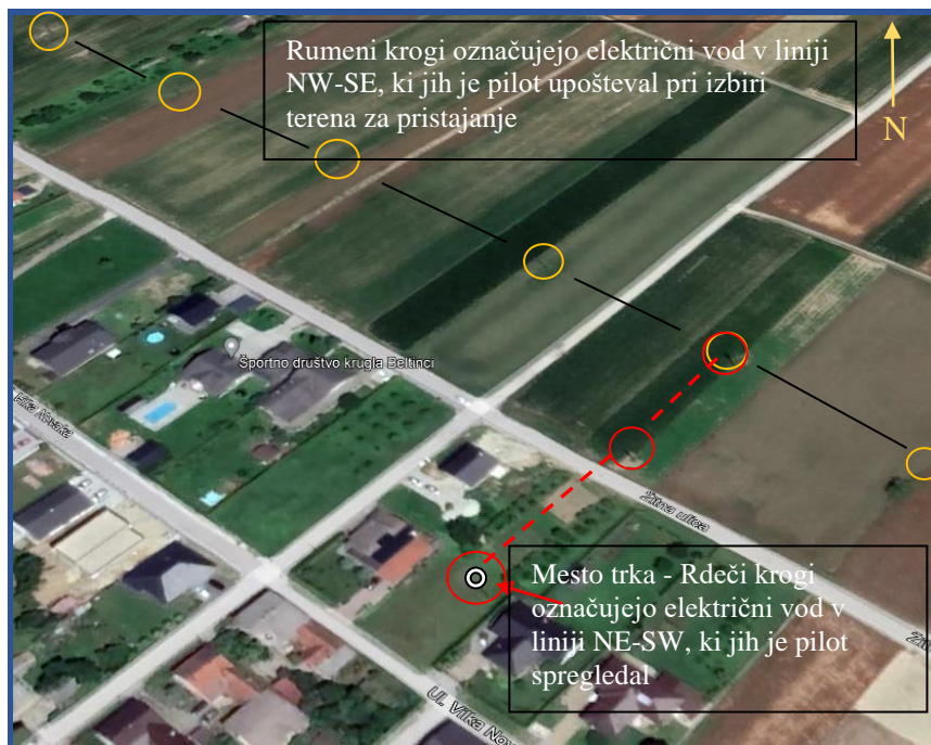
Slika 5: Mesto trka balona in položaj električnih vodov
