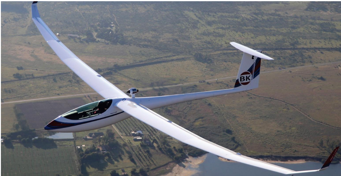
Slika 2: Jadralno letalo Jonker JS-MD 3 s pomožnim JET motorjem
