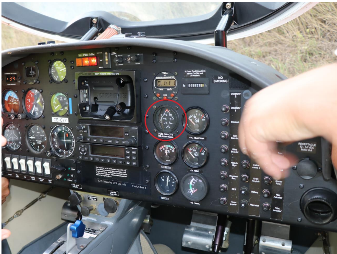
Slika 11: Položaj kazalnikov inštrumenta za gorivo na mestu dogodka
