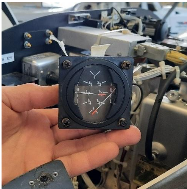
Slika 16: Kazalci inštrumenta ko je kontakt GND povezan
