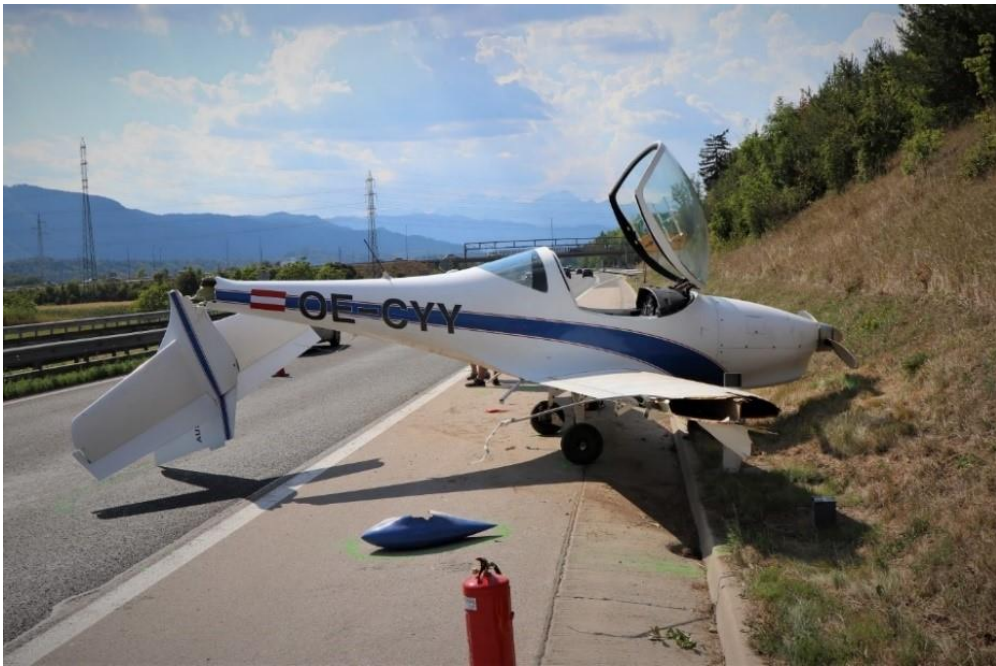
Slika 2: Položaj in poškodbe OE-CYY na mestu ustavitve
