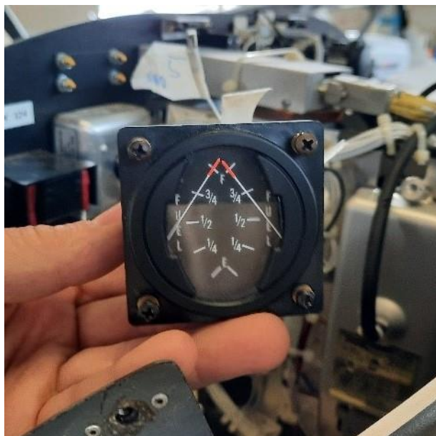
Slika 17: Kazalci inštrumenta ko kontakt GND ni povezan
