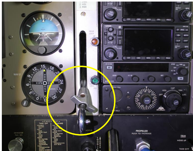
Slika 1: Položaj ročice uvlačljivega podvozja po dogodku
