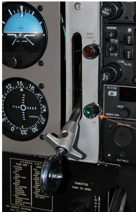
Slika 3: Ročica uvlačljivega podvozja z lažno indikacijo zelene barve, ob močnejši svetlobi pod določenim kotom
