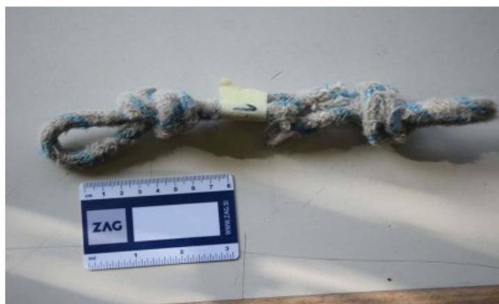
Slika 2: Preskušanec vrvi št. 1 pripravljen za natezno preiskavo.
