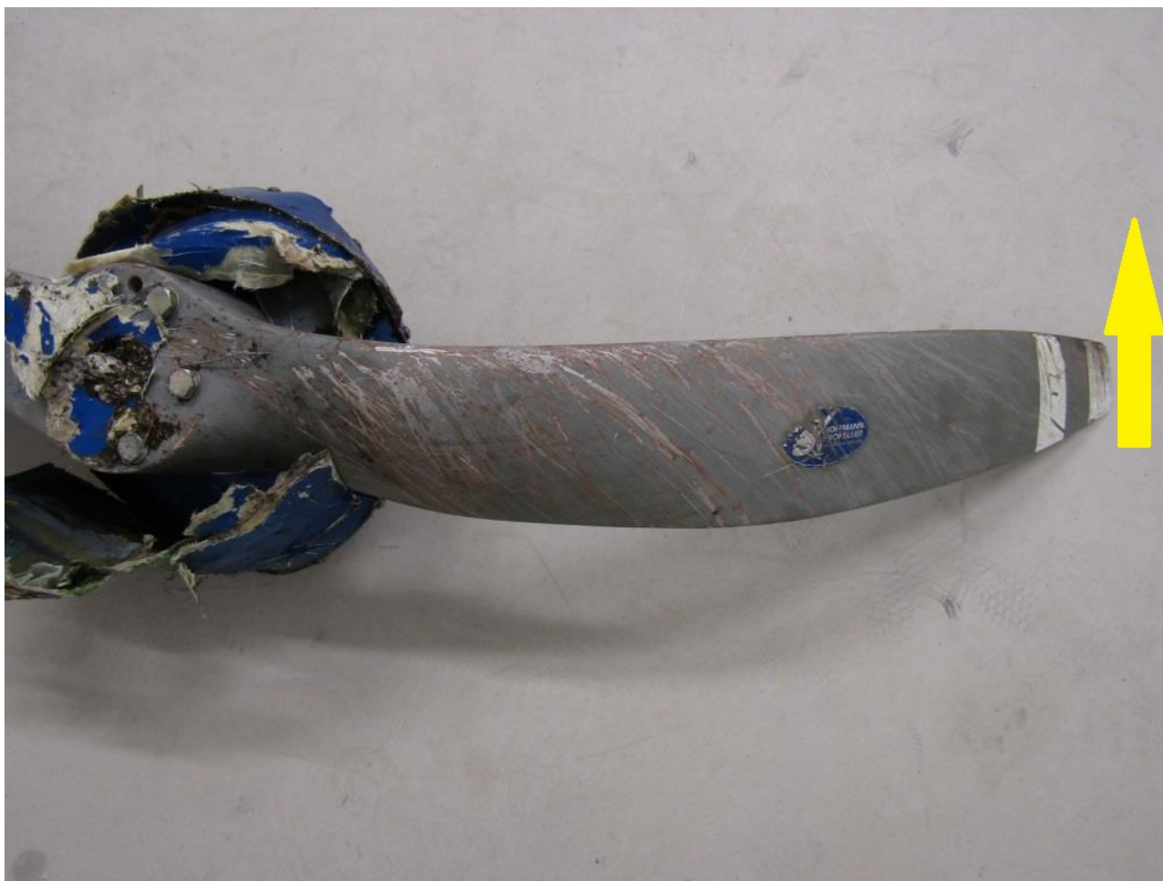
Slika 25: Upognjeni krak propelerja – sprednja stran.
