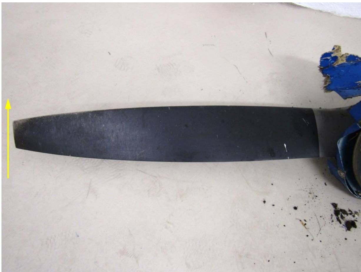
Slika 28: zadnja stran manj poškodovan krak propelerja
