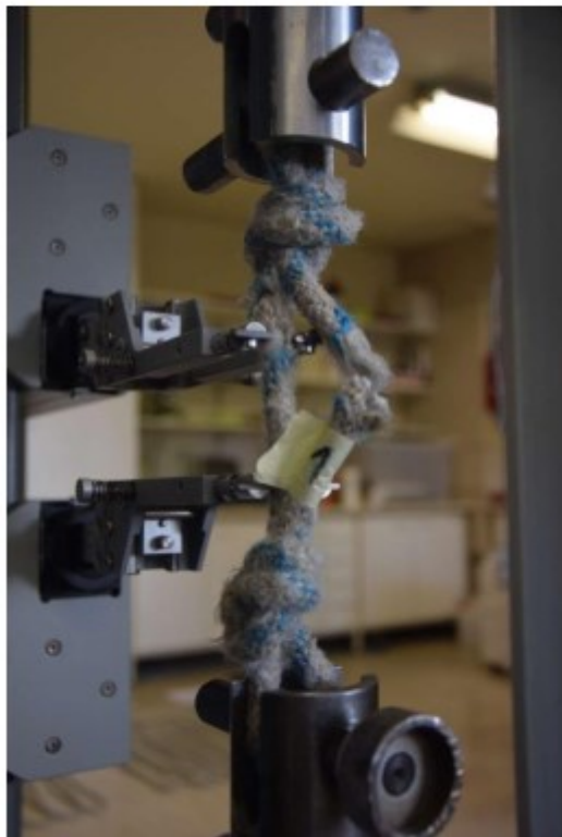
Slika 3: Preskušanec vrvi št. 1 pri natezni preiskavi. Tipala, ki se dotikajo preskušanca so del merilca deformacij - MULTISENZ-a.
