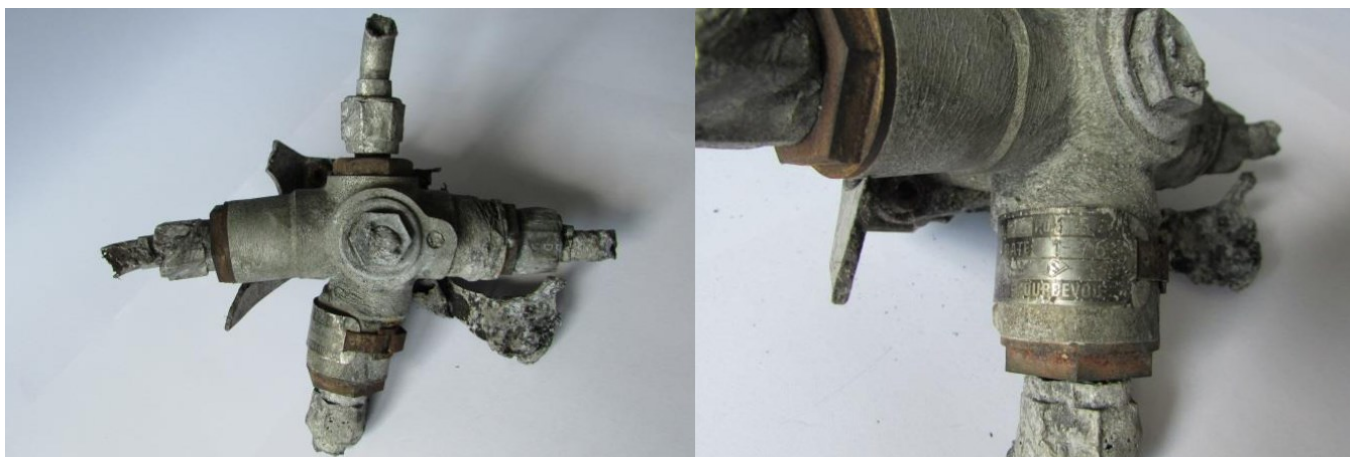
Slika 19: Vizualni pregled gorivnega ventila
