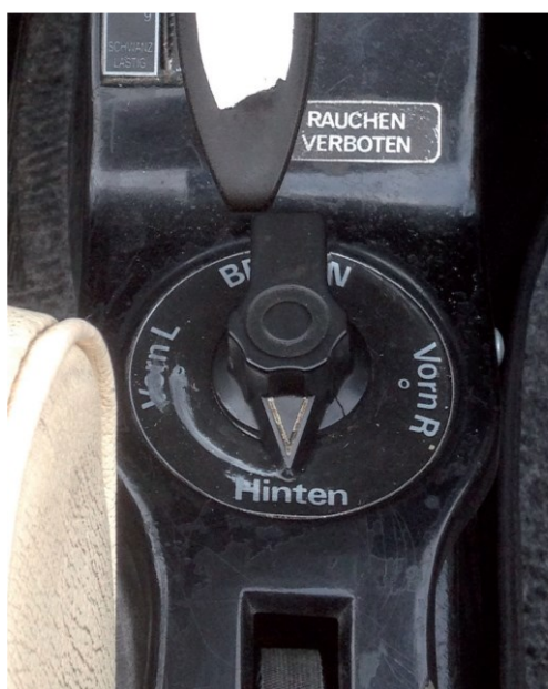
Slika 5: Izbirnik za gorivo v kabini letala D-EFTW
