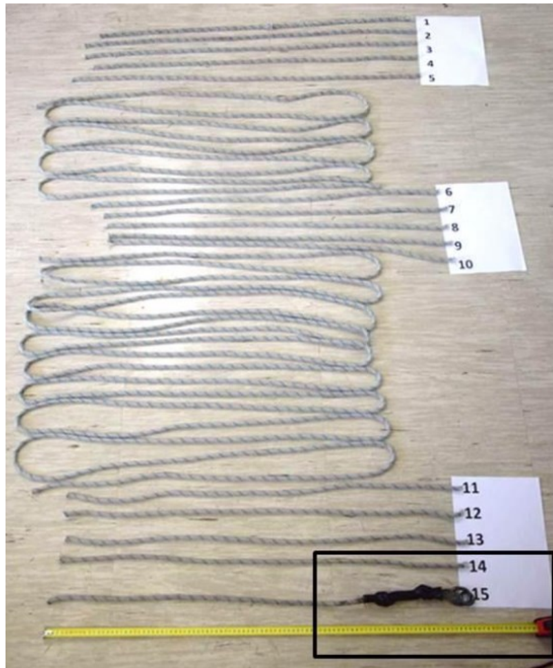
Slika 17: Vizualni pregled uporabljene vlečne vrvi
