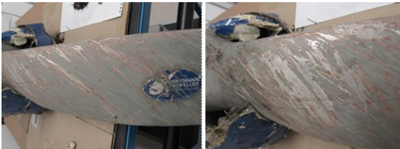
Slika 26: Upognjeni krak propelerja – sprednja stran
