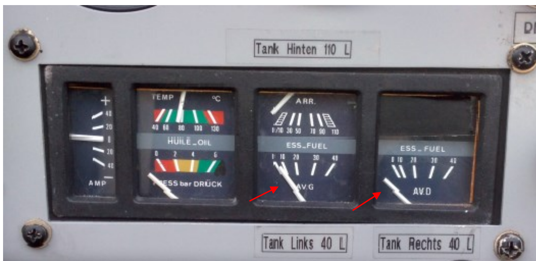
Slika 6: Položaji kazalnikov količine goriva v kabini letala D-EFTW (pri izklopnjenem glavnem stikalu)
