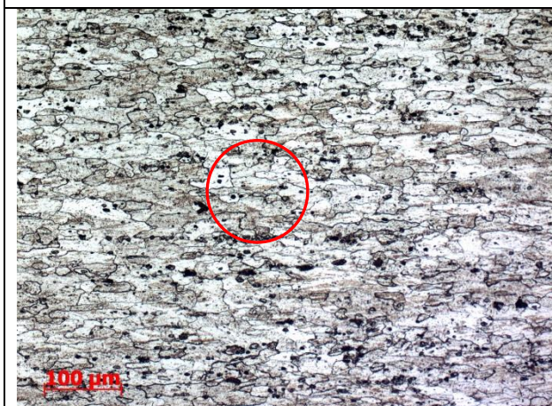
Sliki 110 in 111: Detajli mikrostrukture pločevine zlitine 2024: različni precipitanti intermetalnih spojin so dispergirani po kristalnih zrnih \alpha (jedkano).
