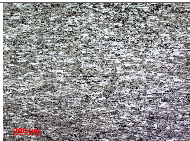
Slika 109: Vzorec 2 – vzdolžni prerez pločevine nosilca v oddaljenosti okoli 20 mm od preloma. Mikrostruktura pločevine je enakomerna preko celotnega prereza, kristalna zrna so deformirana v smeri valjanja pločevine (jedkano).
