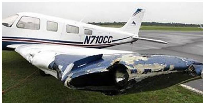
Slika 4: Poškodba levega krila med nevihto, dne 23. 8. 2010 na letališču Bonn/Hangelar (EDKB)
