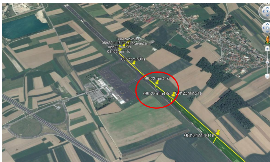
Slika 14: Podatki iz naprave GPS – vzlet z LJMB ob 8.23 – koordinatne točke gibanja letala po manevrski površini na letališču so identične z dejanskim položajem letala pred vzletom in v času vzleta
