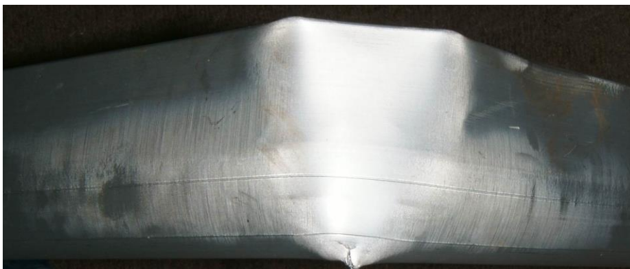
Rekristalizirano področje na desnem profilu. Vidna vdolbina v profilu v zgornjem delu slike
