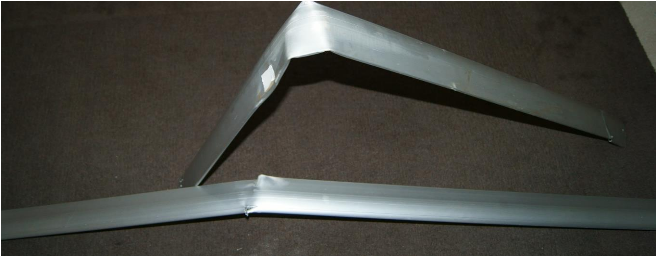
Potek analize. Poškodovani profili. Z belim selotejpm označeno mesto možne predhodne deformacije.
